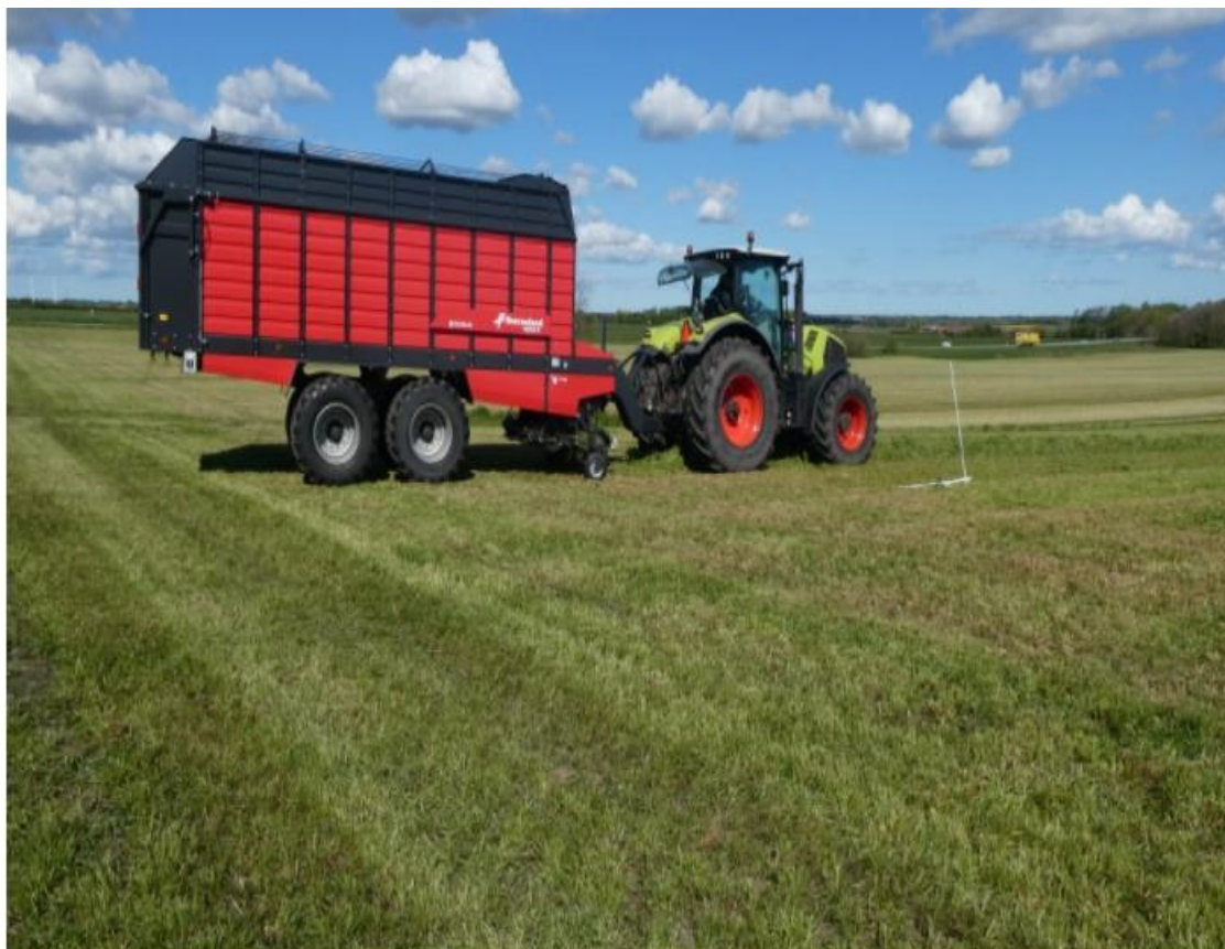
Kverneland skårlægger og opsamlervogn opsamler stort skår i to arbejdsgange.
